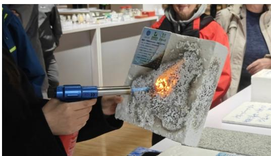
Plastikfolien, Wärmedämmstoff und vieles mehr, weiter verarbeitet werden. Mit dem Brenner wurde gezeigt, dass der aus PLA gewonnene Kunststoff nicht brennbar ist und keine giftigen Dämpfe erzeugt.
